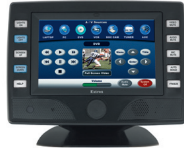
The TLP 700 TV controls the entire AV system.
